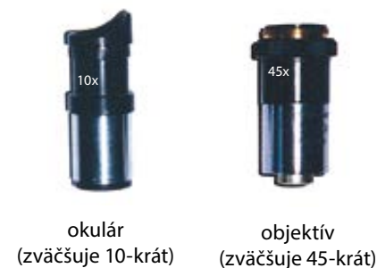
Obr. 7 Hlavné časti mikroskopu
